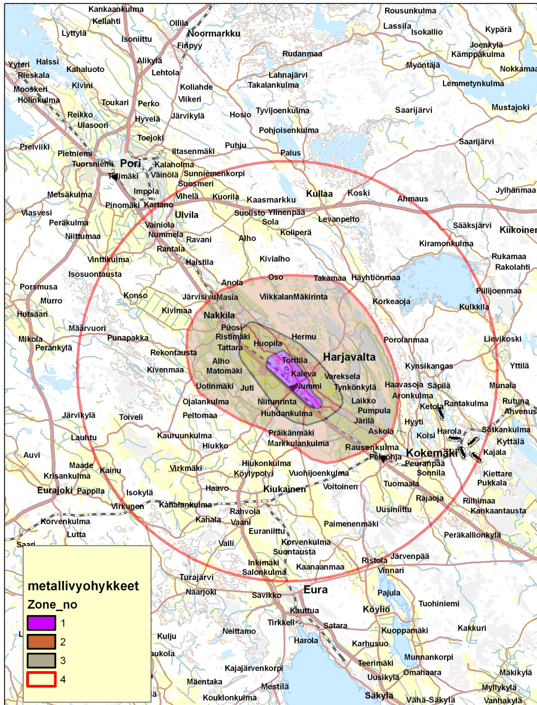
Kuva 24.1 Humuksen metallipitoisuuksien ja karttatarkastelun perusteella laaditut metallikuormitusvyöhykkeet Suurteollisuuspuiston ympärillä.
