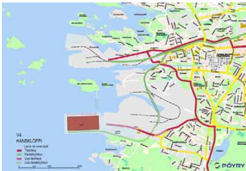
Kuva 10. Rauman sataman laajennusvaihtoehto Hanskloppi.
